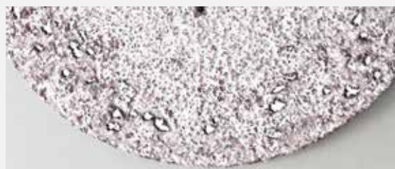
VSM STEARATE Plus : Zachycených třísek je viditelně mnohem méně.
