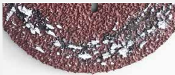
Fibrový kotouč zanesený hliníkovými třískami
